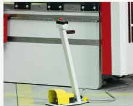
Fußpedal mit NOT-AUS Schalter
