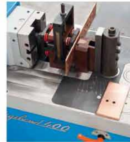
Stanzwerkzeug für Löcher bis Ø 30 mm. Max. Materialstärke 12 mm.
