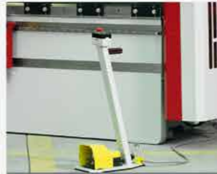
Fußpedal mit Not-Aus Schalter
