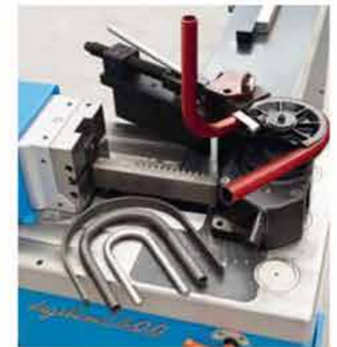
Dreh-Biegewerkzeug für Rohre, Rund- und Rechteckrohre, bis 180°. Max. Ø 50 mm.
