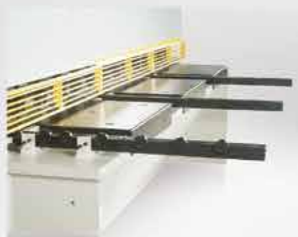
Tisch mit Kugellrollen sowie vordere Auflagearme
