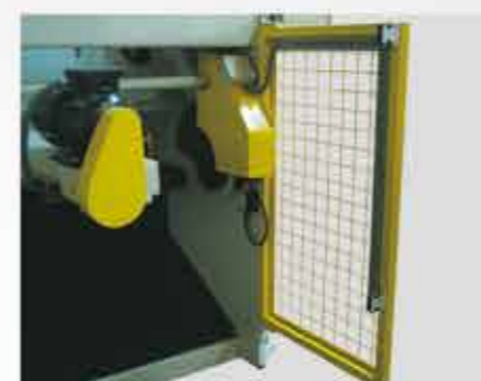
CE Konformität dank Fotozellen System
