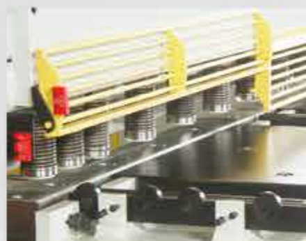
Niederhaltergummis für sicheren Halt des Werkstücks beim Schneiden
