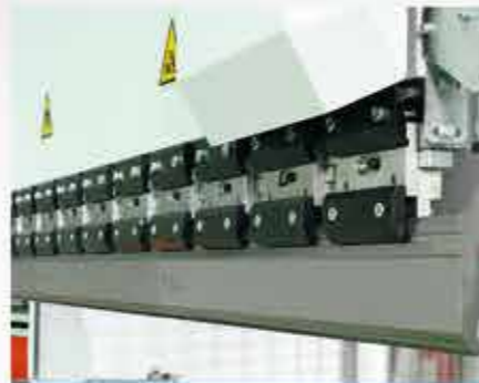
Unterteilte Werkzeugklemmung nach europäischem Standard
