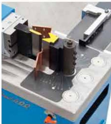
Beweglicher Biegestempel und feste Matrize für enge Biegungen.
