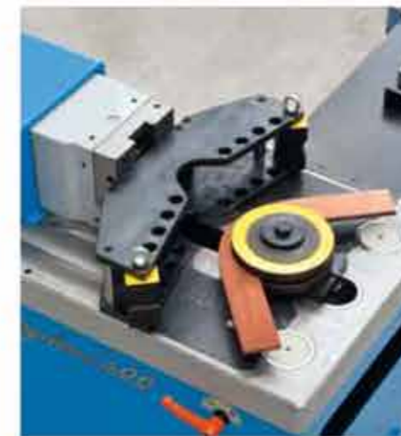
2-Punkt-Biegewerkzeug mit Scheibensatz für Flach- und Formmaterial, bis 90°. Max. 60 x 20 mm.
