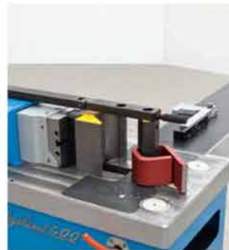
Stempel-Biegestift Ø 80 mm mit Zugbügel zur Biegung von geschlossenen Geometrien mit starkem Material. Max. 200 x 15 mm.
