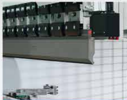
Unterteiltes Oberwerkzeug nach europäischem Standard
