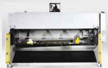
Motorisierter Hinteranschlag mit Bremse und einer Genauigkeit von \pm 0,1\text{mm} , Kugelrollen, 2 Verfahrgeschwindigkeiten, hochqualitatives, gehärtetes Ober- und Unterwerkzeug, Oberwerkzeug mit 2 Schneide
