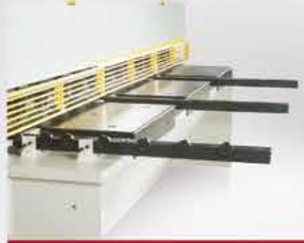
Tisch mit Kugelrollen sowie vordere Auflagearme
