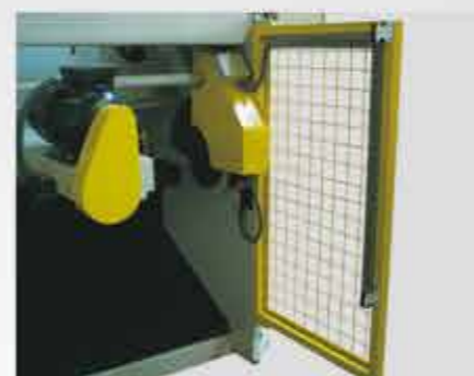
CE Konformität dank Fotozellen System
