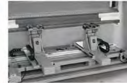
ATF Typ 6-Achsen gesteuert Hinteranschlag: X1-X2-R1-R2-Z1-Z2
