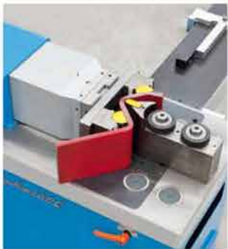
Einzel-V-Werkzeug mit drehenden Stiften (abdruckfreies Biegen) für dickes Material. Max. 200 x 40 mm.
