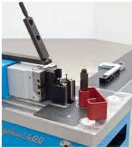
Biegewerkzeug mit Ø 50 mm Aufnahme, H=200 mm, Drehstift-Einzel-V Matrize und Zugbügel. Max. 200 x 8 mm. Eingetragenes Patent.
