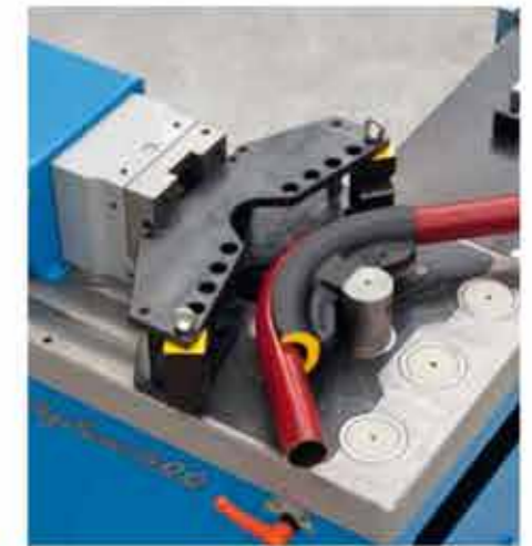
2-Punkt-Biegewerkzeug für dickwandige Rohre von Ø 3/8" Gas (17.2 mm) bis zu Ø 2" Gas (60.3 mm) und Rundmaterial, bis 90°.
